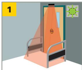
La porte en position fermée, appliquez une tension de 12 à 24 V CA/V CC  $\pm 10\%$  au détecteur. Le voyant DEL clignote en vert jusqu'à ce que la réussite de la configuration en position « porte fermée ».
