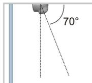
**Montagem no teto** em frente da porta (deslizante, giratória ou basculante)
