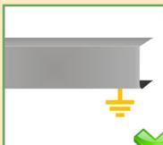
Le dispositif de commande de la porte et le profil du capot du linteau doivent être correctement mis à la terre.
