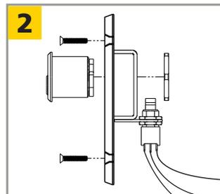
Ajuste la altura del interruptor sobre el soporte hasta que la leva se accione con seguridad cuando gire.
