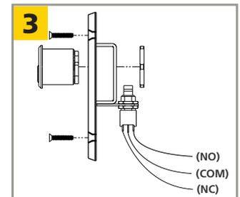
Coloque la instalación eléctrica según las especificaciones.
