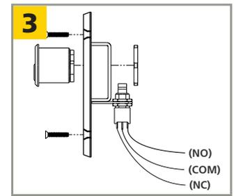
Coloque la instalación eléctrica según las especificaciones.
