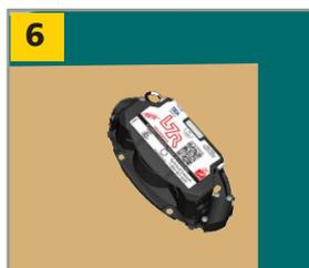
Usando as instruções no gabarito de montagem, monte os sensores **ESCRAVO** com os parafusos apropriados. Conecte a fiação do sensor escravo na porta superior do sensor.
