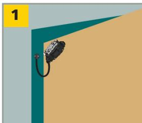
Sensores têm "lateralidade". Determine se o sensor que você está instalando é direito ou esquerdo. A imagem aqui mostra um sensor esquerdo.
