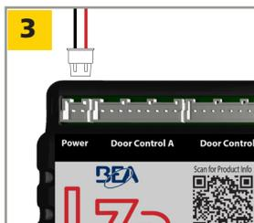
Conecte a fonte de alimentação ou a fiação da fonte de alimentação à porta da central identificada como **Power** (Potência).
