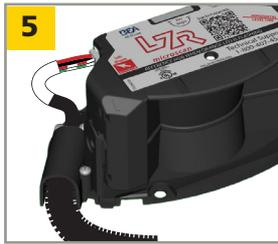
Fixe o circuito da porta ao sensor com a tampa de passagem e três (3) parafusos.<sup>2</sup>
