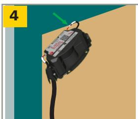
Usando as instruções no gabarito de montagem, monte os sensores **MESTRE** com os parafusos apropriados. Conecte a fiação do sensor escravo na porta superior do sensor.
