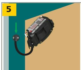
Instale o circuito da porta: Faça um orifício de passagem de  $\frac{1}{2}"$  no encabeçamento e no batente, depois passe a fiação do sensor mestre e instale a tampa.
