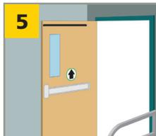
Alinee la carcasa con la parte superior de la puerta y elija el lugar (asegurando una orientación adecuada) y luego marque los orificios de montaje en ambos extremos. *Evite hacer orificios de montaje cerca de las juntas de la puerta.* También marque el extremo adecuado para un orificio de función para paso de cable (si se requiere). Este agujero no puede tener más de 1" de diámetro.
