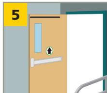
Alignez le boîtier avec le haut de la porte à l'emplacement choisi (assurez-vous de l'orientation adéquate) puis marquez les trous de montage aux deux extrémités. *Évitez de placer les trous de montage près des joints de porte.* Marquez aussi l'extrémité appropriée pour un trou destiné au passage du câble (si nécessaire). Ce trou ne doit pas avoir plus de 1" de diamètre.
