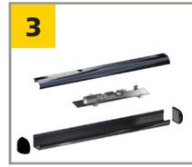
Retirez la carte maître et toutes les cartes esclaves de l'extrusion en tirant sur la languette de la pince de réglage de l'angle vers le bas à partir de l'extrusion et en tournant le circuit imprimé pour le sortir de l'extrusion.
