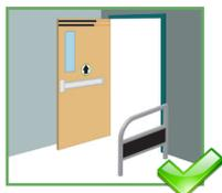
Choisissez un emplacement qui n'interfère pas avec la quincaillerie de porte (p. ex., protège-doigts, tiges de verrouillage, etc.).
