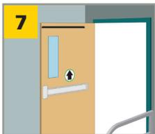
Alignez le boîtier avec les avant-trous et fixez-le à la porte avec les deux vis fournies.
