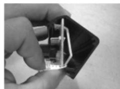
4. Una vez que haya retirado completamente el PCB de la carcasa, podrá cambiar la posición del ángulo. Existen dos abrazaderas por cada Bodyguard, y el ángulo debe coincidir con cada abrazadera del PCB. A continuación, se indican las posiciones.
