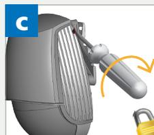
Verrouillez le capot en tournant la vis de blocage dans le sens horaire.
