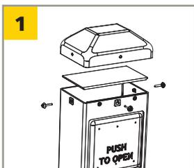
Retire la tapa superior para dejar al descubierto la bandeja de montaje del transmisor.
