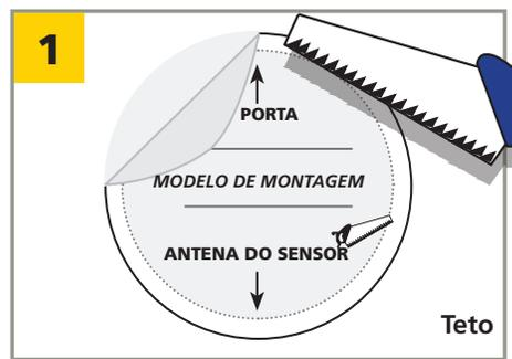
Coloque o modelo de montagem no local desejado para montagem e faça os cortes apropriados.
