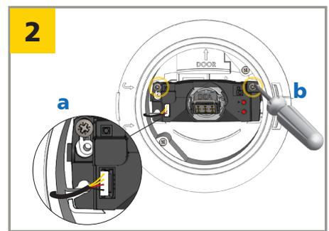
Direcione e conecte o chicote elétrico ao sensor e depois fixe o sensor no acessório de teto.
