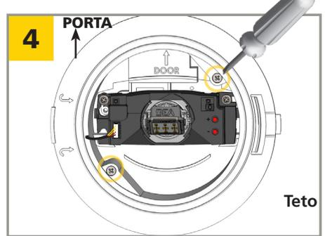
Fixe o acessório de teto ao teto usando os parafusos e porcas de borboleta.
