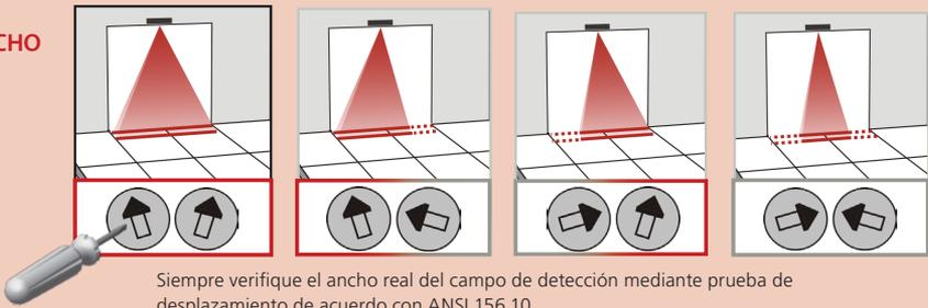
Siempre verifique el ancho real del campo de detección mediante prueba de desplazamiento de acuerdo con ANSI 156.10.
