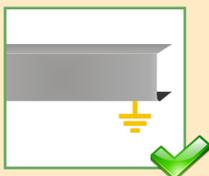
La unidad de control de la puerta y el perfil de la cubierta del cabezal deben tener una conexión a tierra adecuada.
