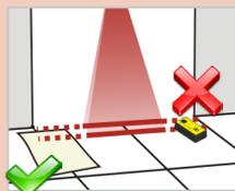
Siempre verifique el ancho real del campo de detección mediante prueba de desplazamiento de acuerdo con ANSI 156.10.
