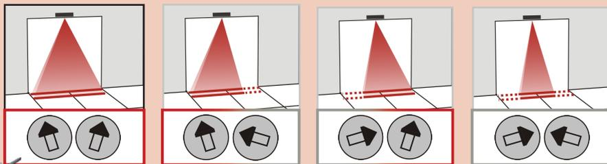
Se puede enmascarar parte del campo de detección para reducir su ancho. La posición de la flecha determina el ancho del campo de detección.
