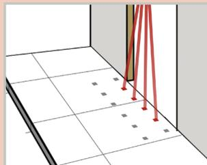
La distancia entre la cortina interior del sensor interno de la puerta y la cortina interior del sensor externo de la puerta siempre deberá ser menor de 8 pulg.
