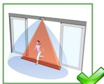
Después de la instalación, siempre pruebe el funcionamiento correcto (según la norma ANSI 156.10) antes de salir del establecimiento.
