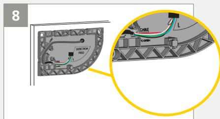
Pase el cable maestro-esclavo a través del orificio y luego coloque el cable en la ranura de la base de montaje y asegúrelo
