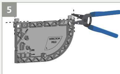
5 Use un cortador de cable para quitar las pestañas de posicionamiento de la base de montaje.
