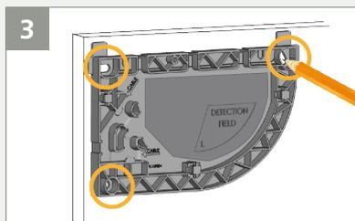
3 Marque los orificios piloto en la puerta. También puede usar la superficie interior de la base de montaje para apretar los tornillos.
