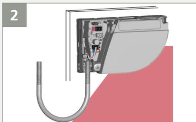
2 Corte el exceso de cable del bucle de la puerta para evitar obstrucciones.
