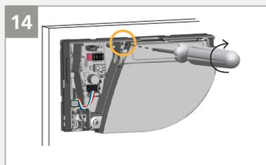
Asegure el tornillo fijador para evitar vibraciones cuando la puerta se mueva.
