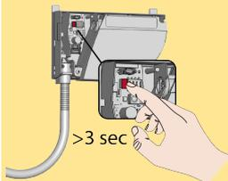
Modo de servicio **desactiva todos los campos de detección** durante 15 minutos y puede ser útil durante una instalación, un aprendizaje mecánico de la puerta o trabajos de mantenimiento.
