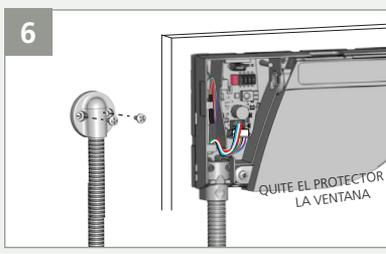
6 Apriete el otro lado del bucle de la puerta por medio del tapón del cable y páselo a través del sobrante del cable eléctrico hacia el controlador de la puerta.
