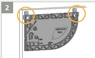
2 Coloque la base de montaje en la puerta. Use las pestañas de posicionamiento para alinear la base correctamente.
