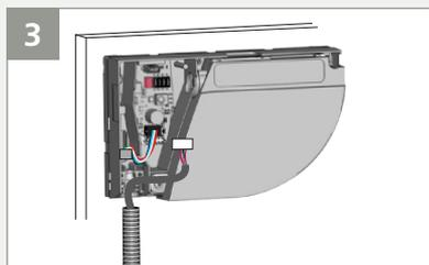
3 Pase el cable de corriente a través del bucle de la puerta y conecte el enchufe blanco al conector blanco. *Compruebe que el bucle no interfiera con la vista del sensor.*
