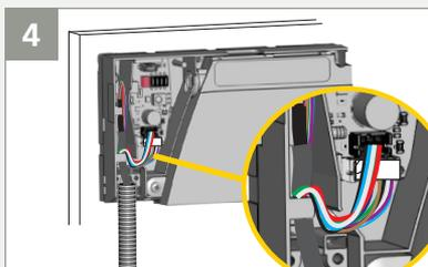
4 Cree un bucle con los cables del cable eléctrico y páselos a través de la ranura como se indica. Use la otra parte del alambre para bloquear los cables.
