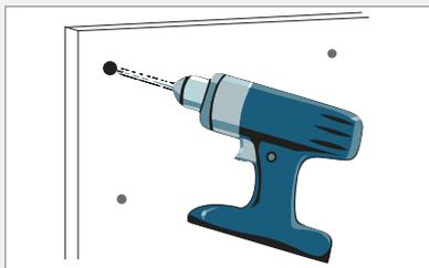
Haga orificios piloto de 1/8" para el montaje del sensor.
