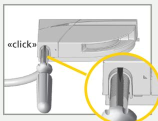
Para remover la cubierta, coloque un destornillador en la ranura y jale hacia arriba hasta que la cubierta se afloje.
