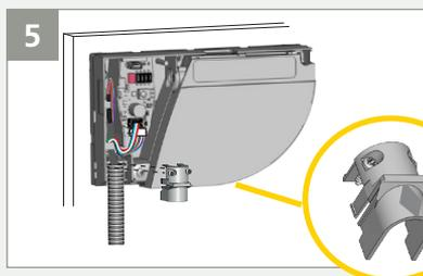
5 Asegure el bucle de la puerta al sensor mediante la abrazadera. Asegure los dos cables para evitar que se estire el cable.
