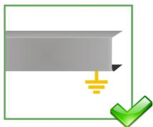
La unidad de control de la puerta y el perfil de la cubierta del cabezal deben tener una conexión a tierra adecuada.
