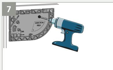
Haga un orificio de paso de  $\frac{5}{16}$ " en la base de montaje y la puerta. Lije todas las orillas rasposas.
