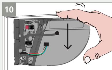
Pase el cable a través del orificio en la parte trasera del sensor y asegure el sensor a la base de montaje deslizándolo hacia abajo.
