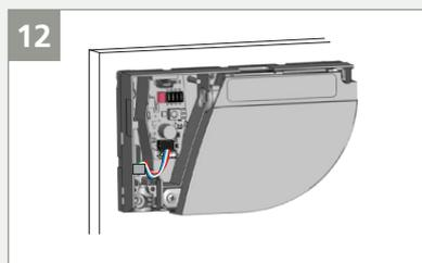
Compruebe que todos los cables estén asegurados en la ranura para evitar daños en la cubierta.
