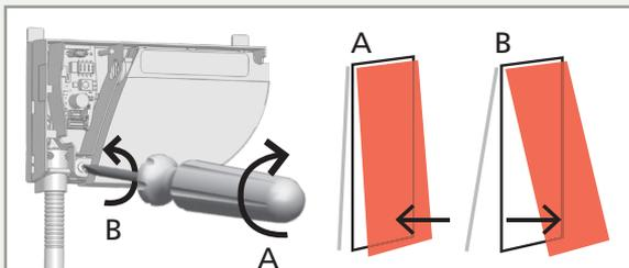
Si es necesario, ajuste el ángulo de inclinación de la cortina del láser girando el tornillo de ajuste del ángulo de inclinación (de 2° a 10°).
