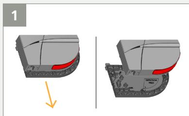
1 Deslice la base de montaje fuera del sensor.
