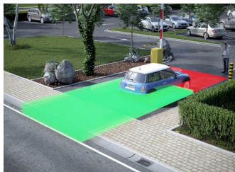
Détection de présence pour portails et barrières
