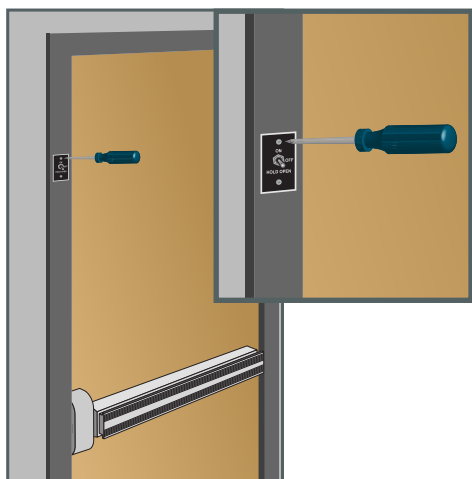
Commutateur MARCHE/ARRÊT/MAINTENIR OUVERT installé
