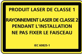
Le dispositif émet des rayons laser invisibles (IR) et visibles qui peuvent être activés pendant le processus d'installation pour régler précisément la position du champ de détection.
