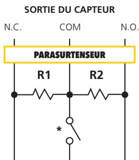
\* La position par défaut de l'interrupteur anti-sabotage est NO.
