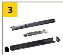
Quite las tarjetas de los circuitos principal y secundario de la extrusión jalando la lengüeta del clip de ajuste de ángulo hacia fuera y abajo de la extrusión y girando la tarjeta del circuito fuera de la extrusión.
