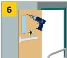
Perfore los orificios marcados (asegurando el tamaño de orificio adecuado).
