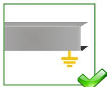
Le bloc-commande de la porte et le profilé du linteau doivent être correctement mis à la terre.
