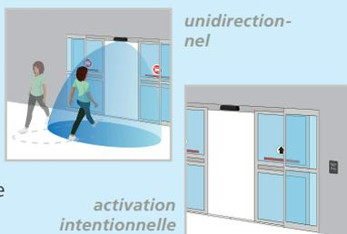
**IMPORTANT :** Le circuit de sécurisation de la porte doit être ignoré en position de porte fermée.
