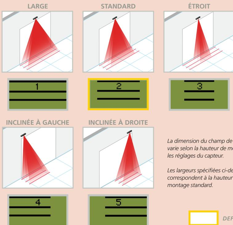
La dimension du champ de détection varie selon la hauteur de montage et les réglages du capteur.
