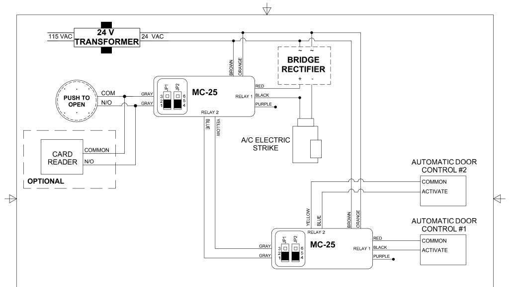
NOTES: 1) JUMPERS ARE PLACED ON J1 PINS 1&2, J2 PINS 4&5 FOR DRY CONTACTS ON RELAY OUTPUT #1.
