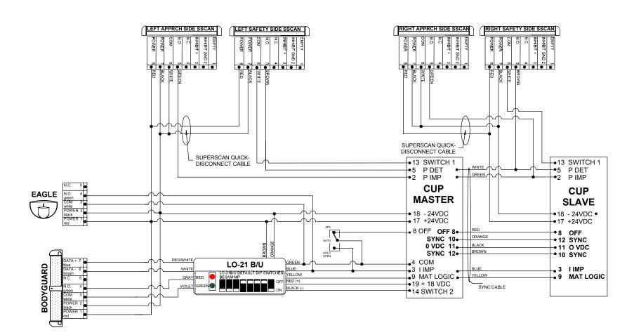
NOTES: 1 ) DO NOT POWER ALL SENSORS FROM MASTER CONTROL BOX. POWER SOME OF THE SENSORS OFF OF THE SLAVE CONTROL.
