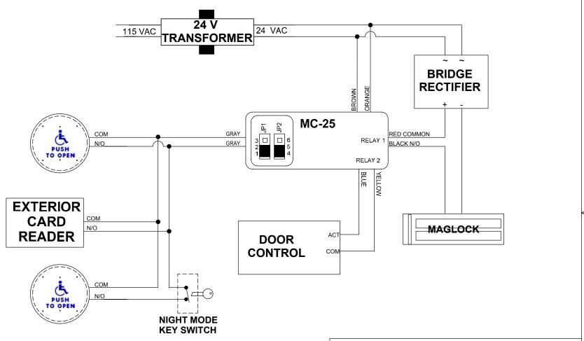
NOTES: 1) JUMPERS ARE PLACE ON J1 PINS 1 &2, J2 PINS 4&5 FOR DRY CONTACTS ON RELAY OUTPUT #1.
