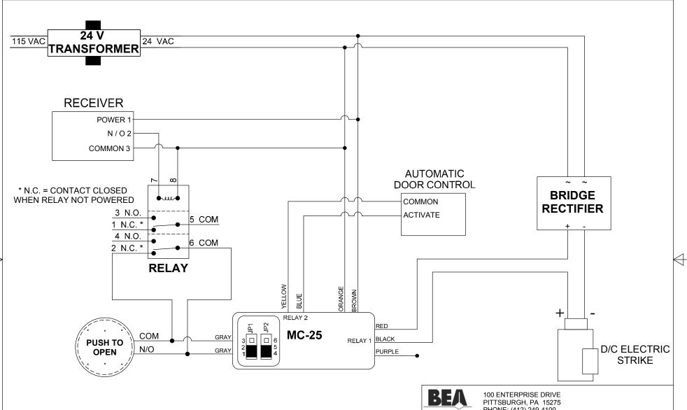
NOTES: 1) JUMPERS ARE PLACED ON J1 PINS 1&2, J2 PINS 4&5 FOR DRY CONTACTS ON RELAY OUTPUT #2.
