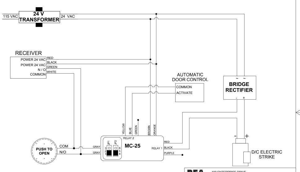
NOTES: 1) JUMPERS ARE PLACED ON J1 PINS 1&2, J2 PINS 4&5 FOR DRY CONTACTS ON RELAY OUTPUT #2.
