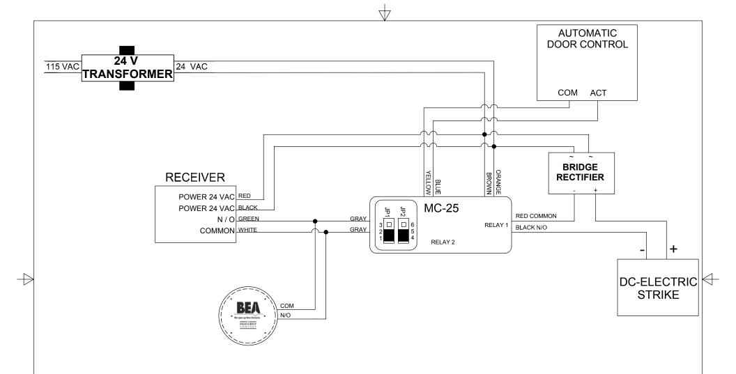
NOTE: 1) JUMPERS ARE PLACED ON J1 PINS 1&2, J2 PINS 4&5 FOR DRY CONTACTS ON RELAY OUTPUT #1.
