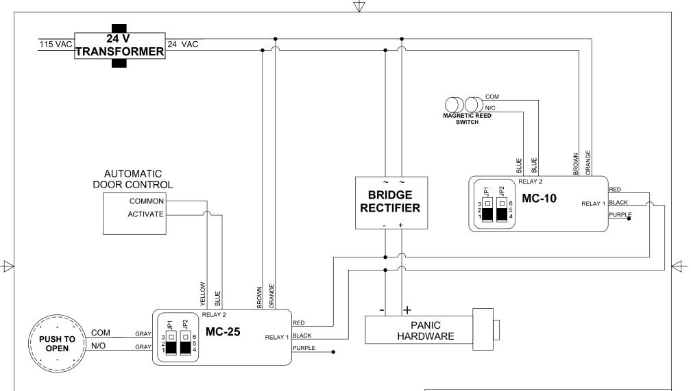
NOTES: 1) JUMPERS ARE PLACED ON J1 PINS 1&2, J2 PINS 4&5 FOR DRY CONTACTS ON RELAY OUTPUT #1.
