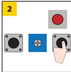
Oprima y suelte el botón de detección deseado (el LED rojo en el receptor se encenderá)<sup>1</sup>.
