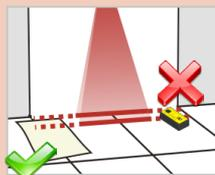
Vérifiez toujours la largeur du champ de détection réelle en effectuant un test de marche conformément aux directives ANSI 156.10.
