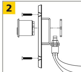
Ajustez la hauteur de l'interrupteur sur le support pour que la came exécute un déclenchement efficace lors de la rotation.
