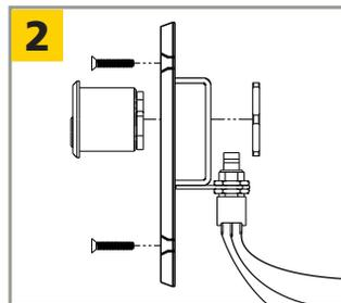
Ajustez la hauteur de l'interrupteur sur le support pour que la came exécute un déclenchement efficace lors de la rotation.
