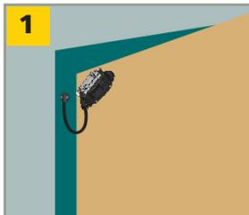
Los sensores son para un lado determinado. Determine si el sensor que está instalando es para el lado derecho o para el izquierdo. *La imagen aquí muestra un sensor del lado izquierdo.*
