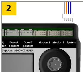
Enchufe el arnés del sistema en el puerto del distribuidor marcado como **System** (Sistema). No enchufe ningún otro arnés.
