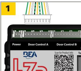
Enchufe el arnés de control de puerta en el puerto del distribuidor marcado como **Door control A** (Control de puerta A).
