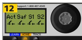
Una vez completado el aprendizaje, la pantalla LCD muestra la pantalla de inicio, el LED azul está apagado y el anaranjado encendido.<sup>1</sup>
