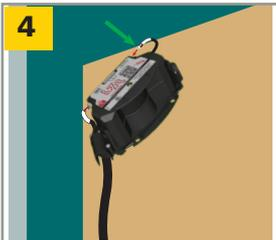
Con las instrucciones de la plantilla de montaje, monte los sensores **MAESTROS** con los tornillos adecuados. Enchufe el arnés del sensor auxiliar en el puerto superior del sensor.
