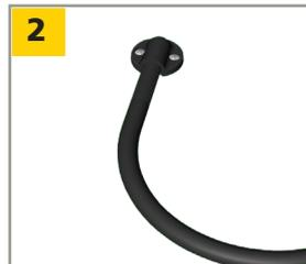
Determine en qué lado de la puerta se instalará el bucle. Corte a la longitud más corta para evitar el bucle en la zona de detección.
