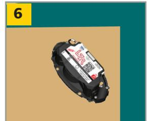
Con las instrucciones de la plantilla de montaje, monte los sensores **ESCLAVOS** con los tornillos adecuados. Enchufe el arnés del sensor auxiliar en el puerto superior del sensor.
