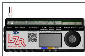
**Los distribuidores/sensores LZR-MICROSCAN T deben estar alimentados por una fuente de alimentación UL Clase 2 limitada a 15 W.**
