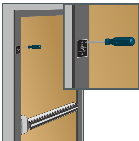
Commutateur MARCHE/ARRÊT/MAINTENIR OUVERT installé
