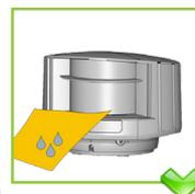
Nettoyez la fenêtre du laser avec de l'air comprimé. Si nécessaire, essuyez uniquement avec un chiffon en microfibre doux, propre et humide.
