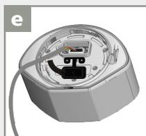
Ouvrez le couvercle de protection, enfichez le connecteur et positionnez le câble dans la fente.
