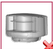
Evite las vibraciones extremas.
