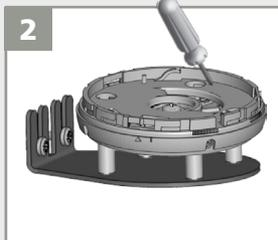
2 Coloque el soporte y asegúrelo con los 4 tornillos para evitar vibraciones.
