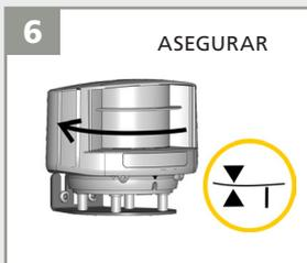
6 ASEGURAR Gire el sensor hasta alinear los dos triángulos.
