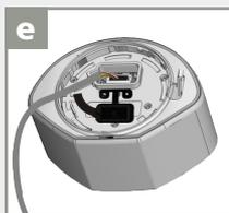
Abra la cubierta de protección, enchufe el conector y coloque el cable en la hendidura.
