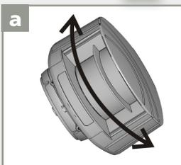
Ajuste la **posición lateral** del campo de detección.
