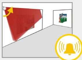
El sensor memoriza el piso como punto de referencia y da una señal de falla cuando se cambia su orientación (observe el LED anaranjado que parpadea).
