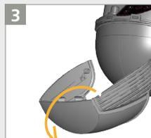
Retire la cubierta completamente antes de instalar el sensor.
