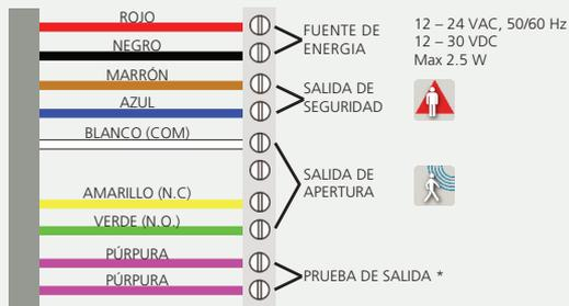
\* El LED del sensor parpadeará por un momento en ROJO durante la comunicación de monitoreo con el control de la puerta. Esto indica que el monitoreo externo es funcional. La funcionalidad de monitoreo debe estar activa en el sensor, el control de la puerta y los cables de monitoreo deben conectarse al control de la puerta como corresponde.
