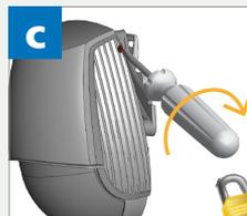
Bloquee la cubierta girando el tornillo de fijación en sentido horario.
