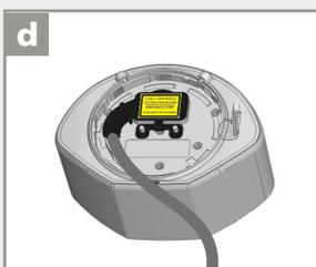
Ouvrez le couvercle de protection, enfichez le connecteur et positionnez le câble dans la fente. Fermez et fixez le couvercle de protection.
