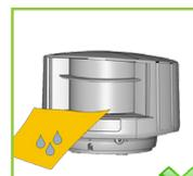
Nettoyez la fenêtre laser à l'air comprimé. Si nécessaire, essuyez-la seulement avec un linge en microfibrilles doux, propre et humide.
