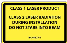
Le dispositif émet des radiations laser visibles et invisibles (IR).
