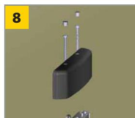
Refixez l'embout supérieur avec les vis fournies et réinsérez les cache-vis.
