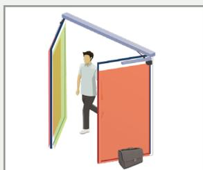
Vérifiez le bon positionnement des champs de sécurisation par un essai de marche conformément aux normes ANSI 156.10.
