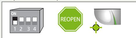
RELAIS 2 : Impulsion RÉOUVERTURE sur le côté de l'approche de la porte.
