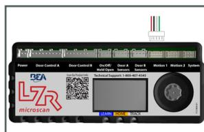
Placas de accionamiento de cable a arnés del sistema (cables grises).
