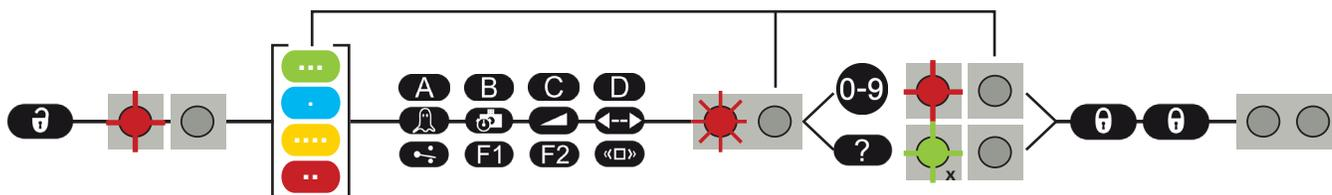
Si es necesario, seleccione el campo de detección correspondiente antes de seleccionar el parámetro y de cambiar el valor. El segundo LED indica el campo de detección.
