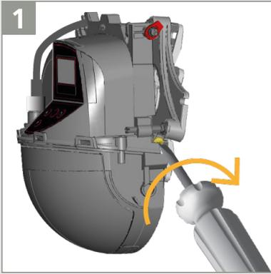
1 Bloquee la posición del sensor asegurando firmemente el tornillo de fijación del ángulo.
