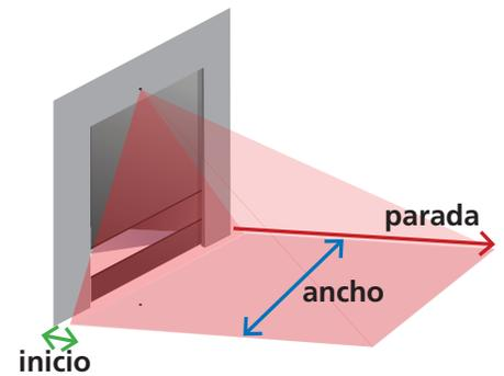
*Para los tres parámetros anteriores, las dimensiones máximas alcanzables se adaptarán automáticamente de acuerdo con la altura de montaje.*
