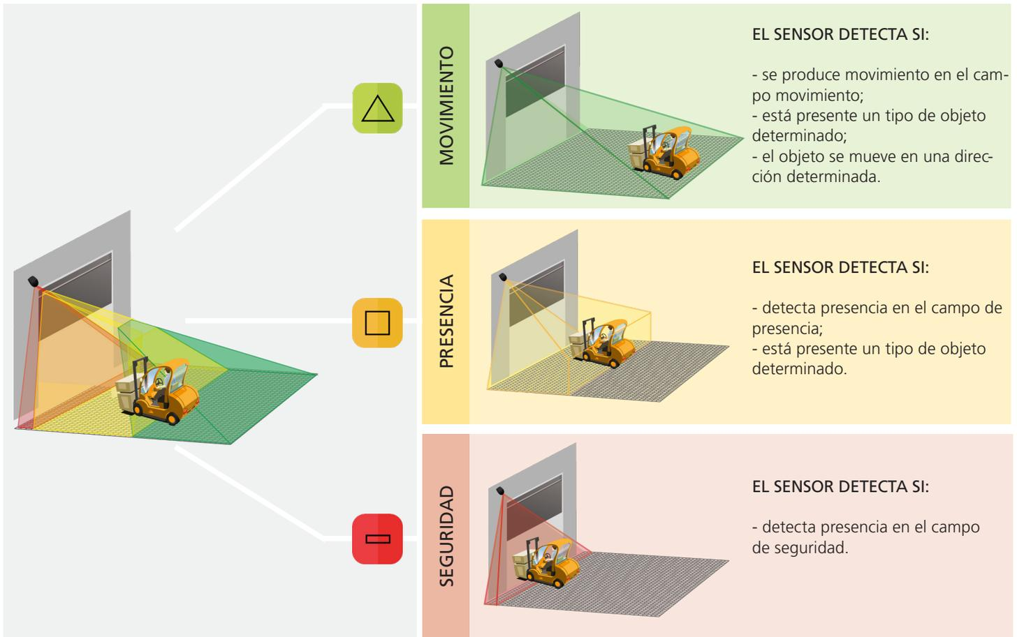
El sensor ofrece 4 funciones de apertura adicionales. Todas las funciones de detección se pueden combinar para activar una salida específica.
