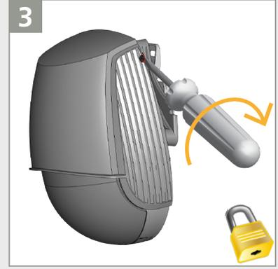
3 Bloquee la cubierta girando el tornillo de fijación en sentido horario.
