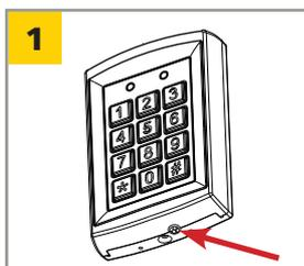
À l'aide de la clé hexagonale fournie, retirez la vis de la face arrière du boîtier sur la surface inférieure du pavé numérique.
