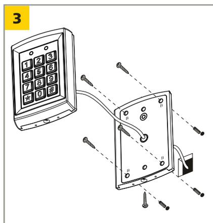
Fixez la face arrière du boîtier au mur à l'aide des vis fournies.
