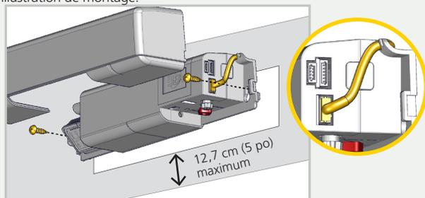
Les connexions du capteur (alimentation et relais) ne doivent être effectuées qu'avec le faisceau fourni.
