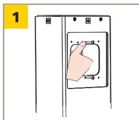
Insérez les vis de fixation de la plaque-poussoir dans le poteau. Laissez la majeure partie des vis hors du trou.
