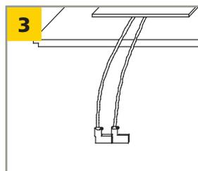
Raccordez les fils de l'émetteur aux bornes NO et COM de la plaque-poussoir.
