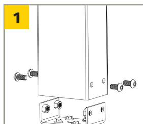
Assoyez le poteau sur le support de fixation et fixez-le à l'aide des quatre (4) boulons.
