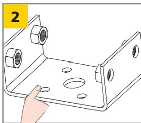
Utilisez le support de fixation pour marquer dans le béton la position des quatre (4) trous d'ancrage.
