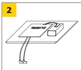
Fixez l'émetteur et la pile au plateau de montage à l'aide de l'attache autoagrippante<sup>1,2</sup>.
