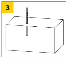
Percez quatre (4) trous de  $\frac{3}{8}$  po dans le béton.
