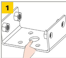
Pour les installations câblées<sup>1</sup>, passez les câbles d'activation par le trou central pour les introduire dans le conduit.
