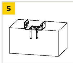
Installez le support de fixation et serrez les écrous fermement.
