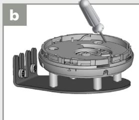
Posicione o suporte e fixe com 4 parafusos para evitar vibrações.
