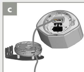
Abra a tampa de proteção, encaixe o conector e posicione o cabo no canal.
