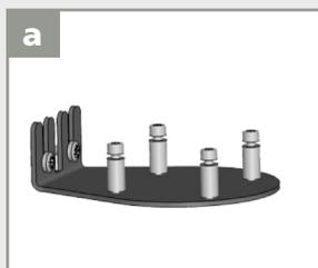
Use uma coluna de montagem ou um acessório de montagem (por exemplo, acessório LBA) para prender o sensor ao poste.
