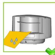
Limpe a janela de laser com ar comprimido. Se necessário, limpe apenas com um pano de microfibras macio, limpo e umedecido.
